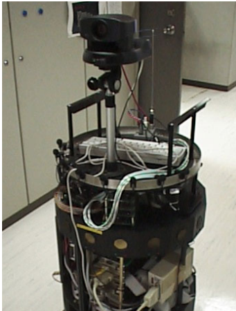
(a) Robot Jijo-2, équipé de 8 microphones
