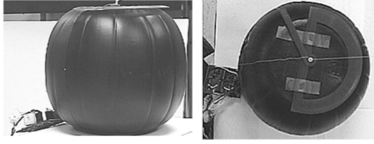
FIG. 2.5 – [Handzel 2003] - Plateforme expérimentale permettant d'étudier l'influence de la présence d'une tête entre deux microphones. La tête est ici émulée par une sphère en plastique, d'un rayon d'environ 10 cm, dont les pôles sont plats.
